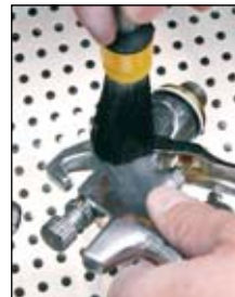
Pinceau passant. Le diluant de nettoyage passe au travers du pinceau
