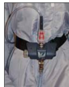
Régulateur de pression et filtre charbon actif
