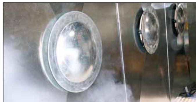
**Prima filtrazione:** sulla nostra lamiera frontale si deposita già una grossa parte della nebulizzazione di pittura e non penetra quasi niente nel filtro di carta
