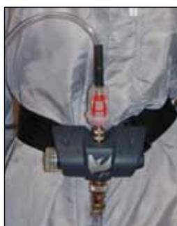
Valvola riduttrice di pressione e filtro al carbone attivo
