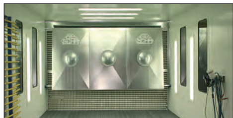
Lackierkabine mit Einbauleuchten
