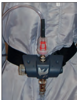
Druckminderventil und Aktivkohlefilter
