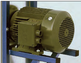
Direktantrieb für einen hohen Wirkungsgrad
