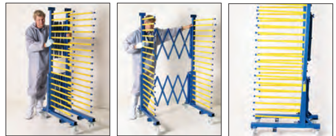
Platzsparend: GESCHA Lacktrockenwagen M2-N Aufrüstbar mit 2 Zwischenrechen
