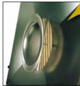
L'ouverture d'aspiration peut être réglée facilement par la buse et ainsi adapter le flux d'air.
