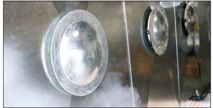
**Stoppeur:** Une grande partie du brouillard de pulvérisation se dépose sur le déflecteur et n'atteint pas le filtre carton.
