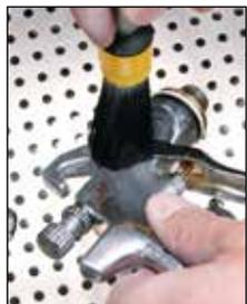
Pinceau passant. Le diluant de nettoyage passe au travers du pinceau
